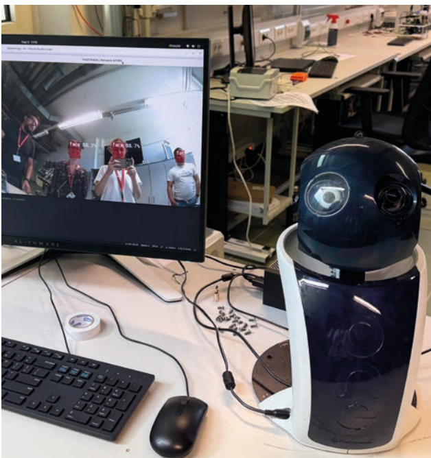
Demonstratoren aus der Abteilung: Echtzeit-Gesichtserkennung mit dem Roboter-Auge (links) und KI-basierte Objekterkennung Demonstrators from the department: real-time facial recognition with the robot eye (left) and AI-based object recognition
