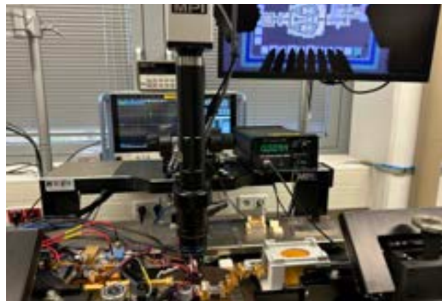
Abbildung 2: Aufbau einer Sub-THz-Messstation zur Charakterisierung einer 600-GHz-Signalquelle auf dem Wafer.
