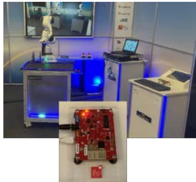
Abbildung 2: In das Netzwerk des Open Labs "Connected Worlds" integrierte KI-gestützte Handgestenerkennung mit einer RADAR-Plattform (unten) zur Steuerung des Roboterarms (oben links)
