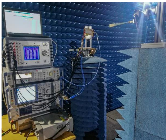
Die Testumgebung: In der Antennenmesskammer konnte die ultraschnelle Datenübertragung nachgewiesen werden. © IHP
