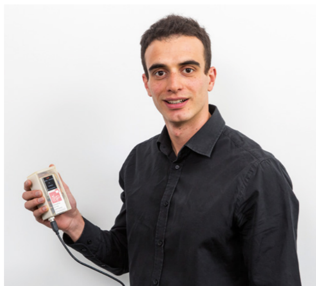
Demonstrator des Projekts EXASENS, mit dem eine Sputumcharakterisierung mit monolithischen SiGe-Hochfrequenzsensoren durchgeführt werden kann. Demonstrator of the project EXASENS, used for Sputum characterization using SiGe high-frequency monolithic sensors.
