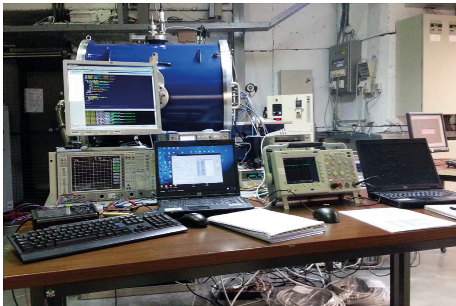
Abb. 4: Der finale Chip bei Strahlungstests an der Université Catholique de Louvain
