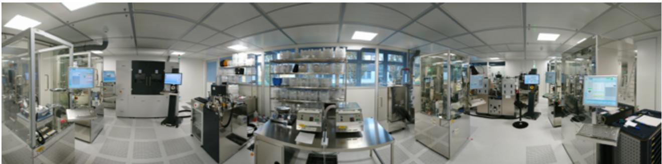
Wafer-Bonding-Pilotlinie für Wafer-Level-Packaging und heterogene Integration
