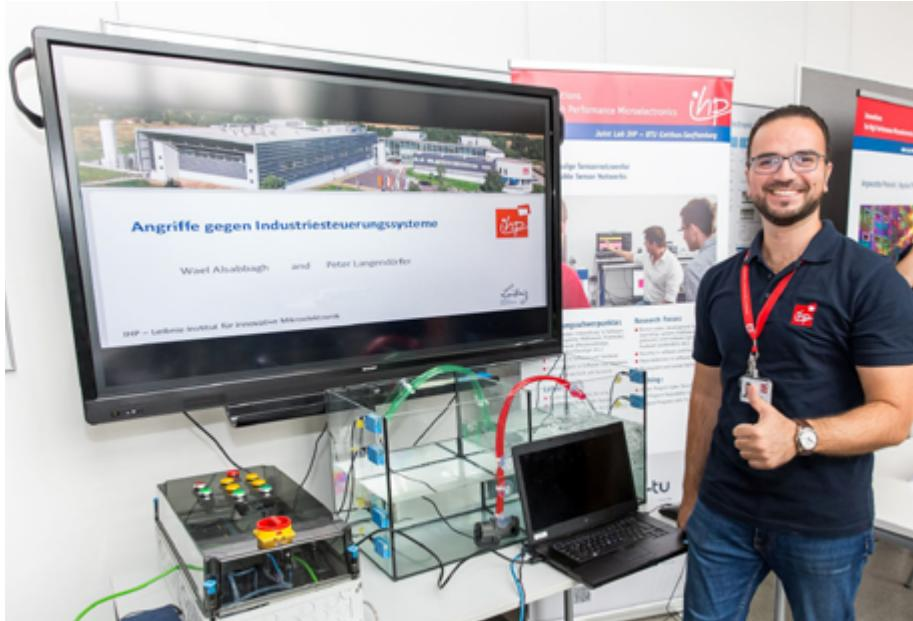
Der vom Kompetenzzentrum entwickelte Demonstrator zeigt eine Industrieanlage, welche eine Flüssigkeit von einem Tank in einen anderen Tank pumpt. Die Pumpe wird durch eine speicherprogrammierbare Steuerung (SPS) geleitet. Zur Überwachung des Füllstands werden kapazitive Näherungssensoren verwendet, die von der SPS ausgewertet werden.
