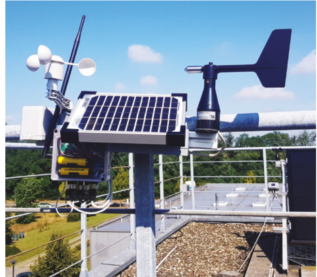
Prototyp einer meteorologischen Station, die im Rahmen des SmartRiver-Projekts entwickelt wurde.
