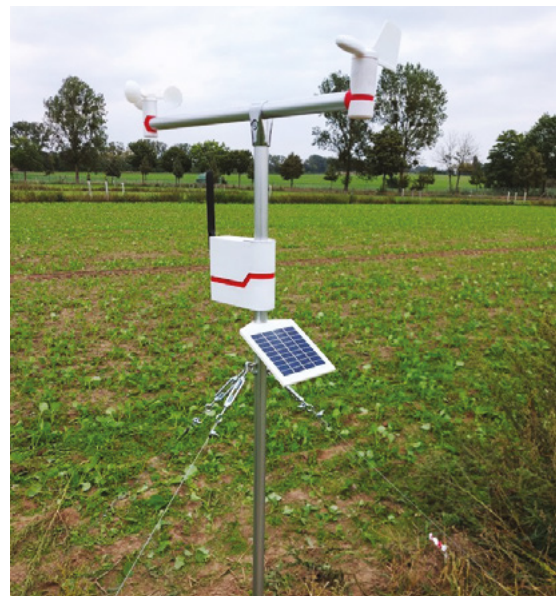
Abb. 19: Installiertes Gateway am DAKIS-Agroforststandort Großmutz, Löwenberger Land Fig. 19: Installed gateway node at DAKIS agroforestry site Großmutz, Löwenberger Land
