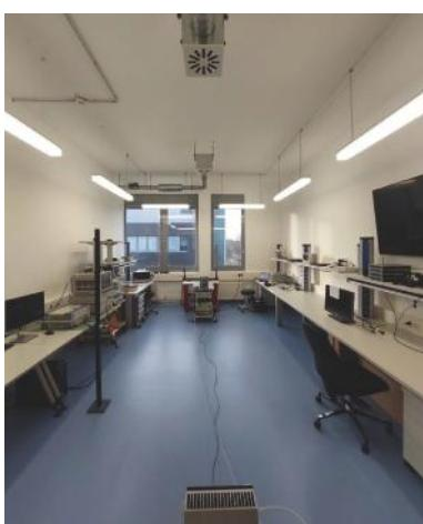
Experimenteller Aufbau zur Objekterkennung mit Hilfe eines 60-GHz-Kommunikationssystems in einem Laborraum
