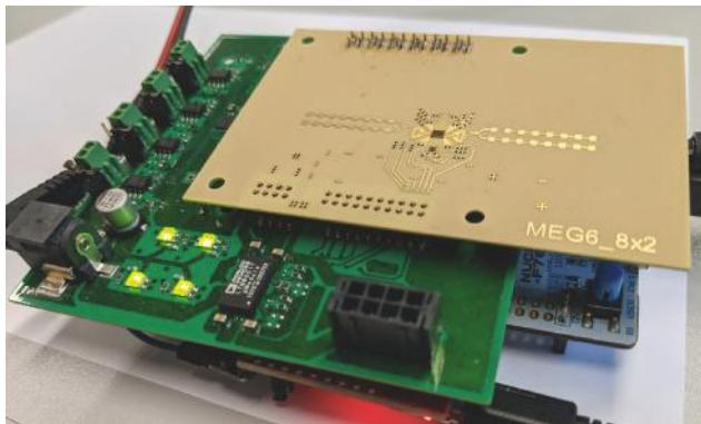
Abb. 1: Demonstrator eines medizinischen Radarsystems im Test
