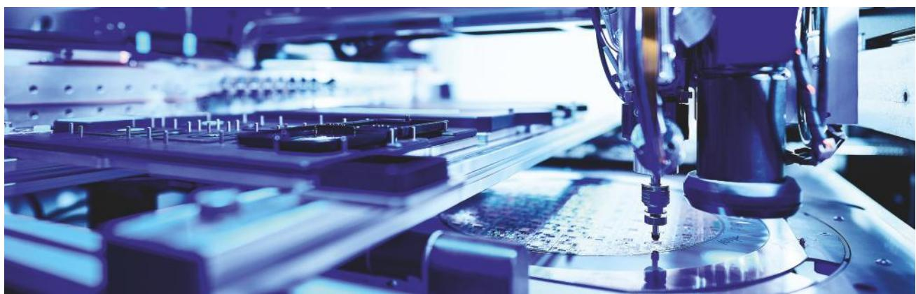
Pick & Place-Robotersystem entnimmt gewürfelte Chips
