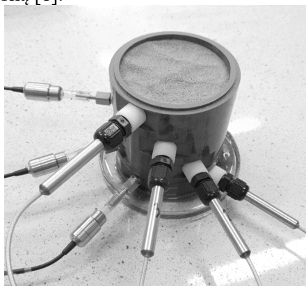
Rys.2. Kolumna gruntowa z sondami wprowadzonymi w próbkę piasku na czterech poziomach wysokości. Fig.2. A soil column with probes inserted into the sand sample at four height levels.
